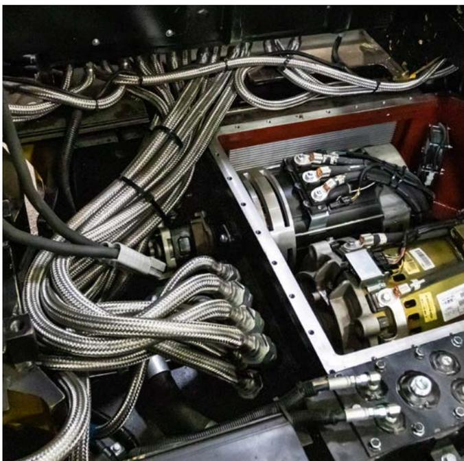
Les CÂBLES À CONDUIT FLEXIBLE (CF) abritent le câblage ordinaire, qui est scellé pour garantir une utilisation sûre dans un environnement classé EX. Le câble CF offre flexibilité et gain d'espace.
