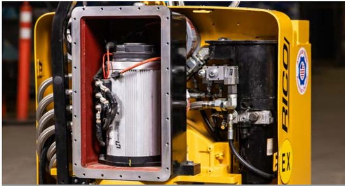
Les **BOÎTIERS D'ENTRAÎNEMENT, DE POMPE ET ÉLECTRIQUES** n'abritent que des composants électriques et sont approuvés pour être inclus sur les chariots élévateurs de catégorie EX. Tous les boîtiers RICO ont été testés pour approbation dans un environnement classé EX par FM Global.
