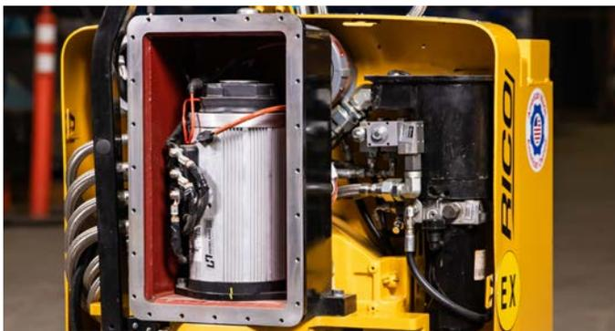
**LOS RECINTOS DE DIRECCIÓN, BOMBA Y SISTEMAS ELÉCTRICOS** albergan solo componentes eléctricos y están aprobados para incluirse en los montacargas con clasificación EX. Todos los recintos RICO se aprobaron por FM Global tras ser evaluados en un entorno con clasificación EX.
